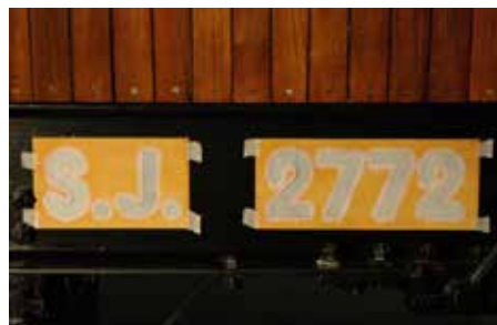
Här efter det första lagret med vit lackfärg.
