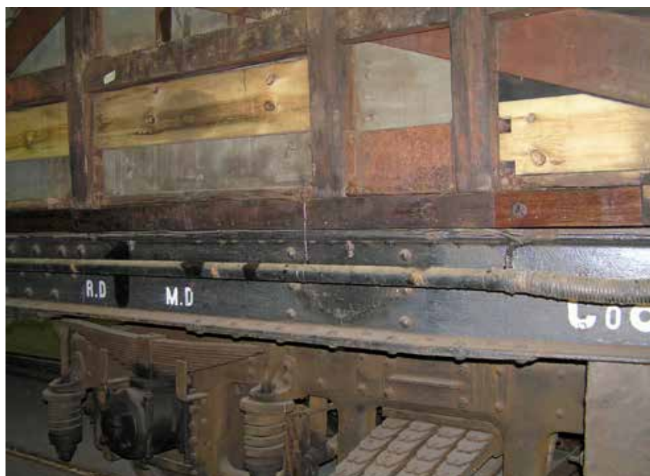
Underredet innan åtgärder. Här syns också en del av stommen och en del av en boggi innan åtgärder.
