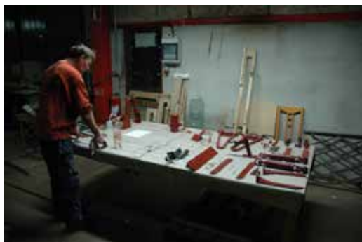
Rostskyddsbehandling efter blästring av slutsignalhållare och delar till bälgen gjordes av Thom Olofsson.
