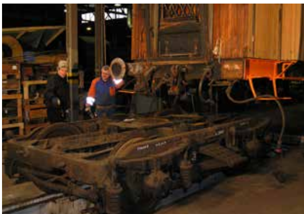
En av de boggier som ska åtgärdas rullas ut under vagnen av Rolf Jansson och Sten Holm. Vagnen hålls uppe av vagnlyftare. På bilden syns också den gavel som lämnades som en referensyta.
