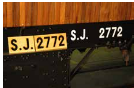
Färdigmålad märkning, det är tre lager med vit färg som har lagts på.
