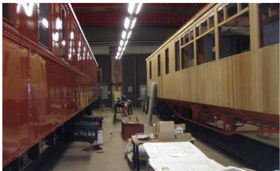
Co8d 3137 är leveransklar efter restaureringen, förutom batterilådorna som åtgärdas på bilden. Till höger restaurangvagnen Ro2 2702.
