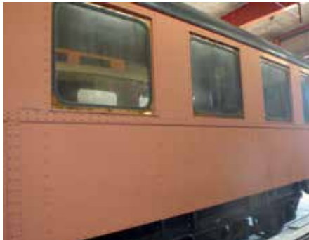
Sidofönster innan byte.
